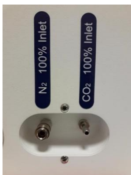
Εικόνα 11.1 Είσοδοι αερίου στο πίσω μέρος των επωαστήρων εξωσωματικής γονιμοποίησης Mini MIRI® Dry και Επωαστήρας εξωσωματικής γονιμοποίησης πολλαπλών θαλάμων Mini MIRI® Humidity
