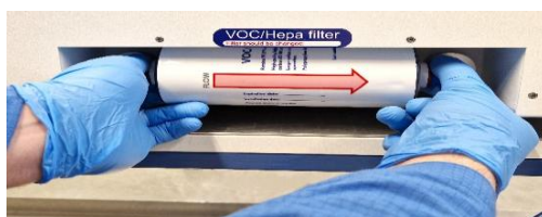
Εικόνα 12.2 Διαδικασία εισαγωγής και αφαίρεσης φίλτρου VOC/HEPA
