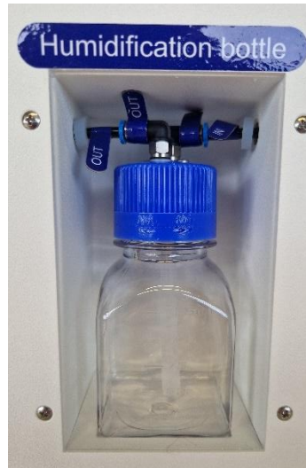
Εικόνα 22.1 Σύνδεση σωλήνα στη φιάλη ύγρανσης και στον επωαστήρα εξωσωματικής γονιμοποίησης πολλαπλών θαλάμων Mini MIRI® Humidity
